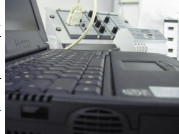
Programmierplatz für LON-BUS oder mit Schnittstelle RS 485
